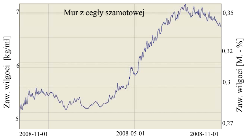
Rys. 3.8. Zmiany zawartości wilgoci w warstwie wewnętrznej – okładzina szamotowa
